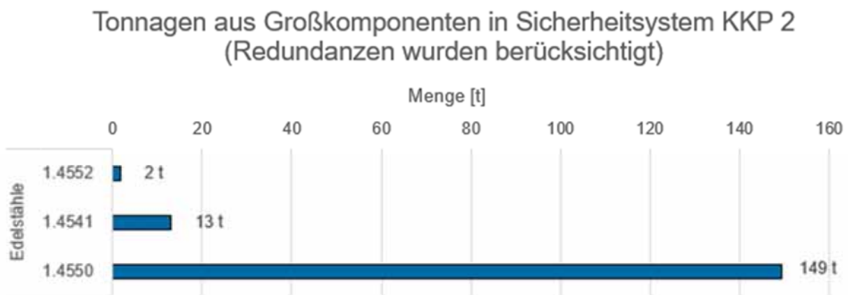
Abbildung 3-4: Tonnagen aus Großkomponenten im Sicherheitssystem KKP 2
